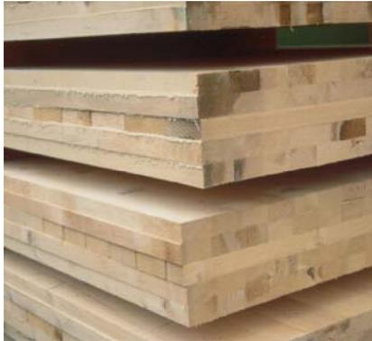
**Abbildung 2** Brettsperrholzelemente, noch unbesäumt
